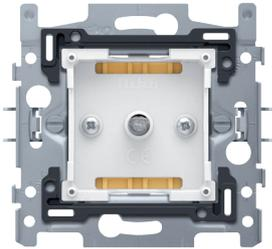
Mechanismus für Drehschalter für Motoren 25 A mit 3 Geschwindigkeitsstufen, nämlich: 1-0-2, Krallenbefestigung. Eine Zentralplatte und eine Blende in der gewünschten Farbe müssen separat bestellt werden.
