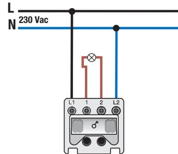
Mechanismus für einen zweipoligen Schalter, zweipoligen Bedienschalter oder zweipoligen Zugschalter, mit Krallenbefestigung. Mit einem zweipoligen Schalter können Sie eine Lampe oder mehrere parallel geschaltete Lampen ein- und ausschalten. Abdeckung und Rahmen in der Farbe Ihrer Wahl müssen separat bestellt werden.
