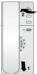
fig.5b: encliqueter l'avant sur la base du poste intérieur
