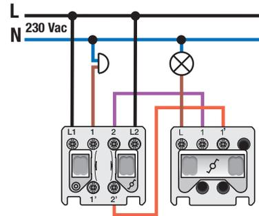
Mechanismus für einen Doppelschalter, mit Krallenbefestigung: einen Wechselschalter und einen als Schließerkontakt ausgeführten Taster. Wechselschalter werden verwendet, um eine Lampe von zwei verschiedenen Orten aus zu bedienen. Zentralplatte und Rahmen in der Farbe Ihrer Wahl müssen separat bestellt werden.
