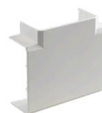
dévidement permet, à l'aide d'un cutter, de raccourcir le raccordement en T de 50 à 26mm. Cette pièce est fabriquée en PC-ASA blanc, coloré dans la masse (RAL9010). Résistant aux rayons ultraviolets. Degré de protection: IP40. Résistance d'isolement: =100M?. Résistance aux chocs: IK07. 230V-16A. Température de service: en transport -25°C à 60°C, en installation: -5°C à 60°C. Les accessoires portent le label CE et répondent aux normes KEMA K55A-W2-W3.
