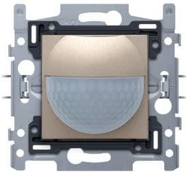
Grâce à ce détecteur de mouvement intérieur intégré avec contact de commutation 10 A, 230 V, vous disposez d'un angle de détection de 180° à l'horizontale et de 60° à la verticale pour détecter tout mouvement. Lors de la détection d'un mouvement, les lampes s'allument conformément aux réglages que vous avez prédéfinis. Couleur de finition: champagne coated
