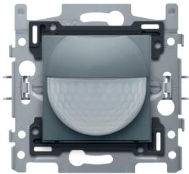
Grâce à ce détecteur de mouvement intérieur intégré avec contact de commutation 10 A, 230 V, vous disposez d'un angle de détection de 180° à l'horizontale et de 60° à la verticale pour détecter tout mouvement. Lors de la détection d'un mouvement, les lampes s'allument conformément aux réglages que vous avez prédéfinis. Couleur de finition: alu steel grey coated
