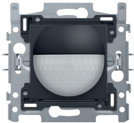
Grâce à ce détecteur de mouvement intérieur intégré avec contact de commutation 10 A, 230 V, vous disposez d'un angle de détection de 180° à l'horizontale et de 60° à la verticale pour détecter tout mouvement. Lors de la détection d'un mouvement, les lampes s'allument conformément aux réglages que vous avez prédéfinis. Couleur de finition: anthracite
