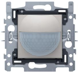
Grâce à ce détecteur de mouvement intérieur intégré avec contact de commutation 10 A, 230 V, vous disposez d'un angle de détection de 180° à l'horizontale et de 60° à la verticale pour détecter tout mouvement. Lors de la détection d'un mouvement, les lampes s'allument conformément aux réglages que vous avez prédéfinis. Couleur de finition: light grey
