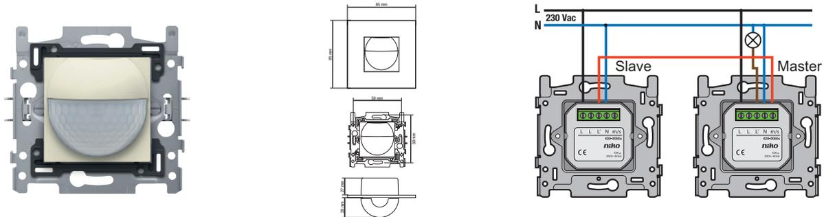
Grâce à ce détecteur de mouvement intérieur intégré avec contact de commutation 10 A, 230 V, vous disposez d'un angle de détection de 180° à l'horizontale et de 60° à la verticale pour détecter tout mouvement. Lors de la détection d'un mouvement, les lampes s'allument conformément aux réglages que vous avez prédéfinis. Couleur de finition: cream
