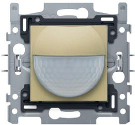
Grâce à ce détecteur de mouvement intérieur intégré avec contact de commutation 10 A, 230 V, vous disposez d'un angle de détection de 180° à l'horizontale et de 60° à la verticale pour détecter tout mouvement. Lors de la détection d'un mouvement, les lampes s'allument conformément aux réglages que vous avez prédéfinis. Couleur de finition: alu gold coated
