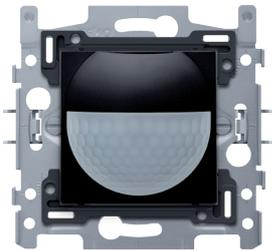
Grâce à ce détecteur de mouvement intérieur intégré avec contact de commutation 10 A, 230 V, vous disposez d'un angle de détection de 180° à l'horizontale et de 60° à la verticale pour détecter tout mouvement. Lors de la détection d'un mouvement, les lampes s'allument conformément aux réglages que vous avez prédéfinis. Couleur de finition: black coated
