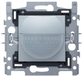
Grâce à ce détecteur de mouvement intérieur intégré avec contact de commutation 10 A, 230 V, vous disposez d'un angle de détection de 180° à l'horizontale et de 60° à la verticale pour détecter tout mouvement. Lors de la détection d'un mouvement, les lampes s'allument conformément aux réglages que vous avez prédéfinis. Couleur de finition: sterling
