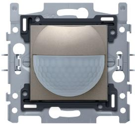
Grâce à ce détecteur de mouvement intérieur intégré avec contact de commutation 10 A, 230 V, vous disposez d'un angle de détection de 180° à l'horizontale et de 60° à la verticale pour détecter tout mouvement. Lors de la détection d'un mouvement, les lampes s'allument conformément aux réglages que vous avez prédéfinis. Couleur de finition: bronze
