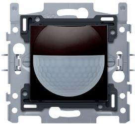
Grâce à ce détecteur de mouvement intérieur intégré avec contact de commutation 10 A, 230 V, vous disposez d'un angle de détection de 180° à l'horizontale et de 60° à la verticale pour détecter tout mouvement. Lors de la détection d'un mouvement, les lampes s'allument conformément aux réglages que vous avez prédéfinis. Couleur de finition: dark brown
