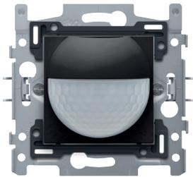
Grâce à ce détecteur de mouvement intérieur intégré avec contact de commutation 10 A, 230 V, vous disposez d'un angle de détection de 180° à l'horizontale et de 60° à la verticale pour détecter tout mouvement. Lors de la détection d'un mouvement, les lampes s'allument conformément aux réglages que vous avez prédéfinis. Couleur de finition: Bakelite® piano black coated
