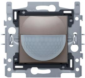
Grâce à ce détecteur de mouvement intérieur intégré avec contact de commutation 10 A, 230 V, vous disposez d'un angle de détection de 180° à l'horizontale et de 60° à la verticale pour détecter tout mouvement. Lors de la détection d'un mouvement, les lampes s'allument conformément aux réglages que vous avez prédéfinis. Couleur de finition: greige
