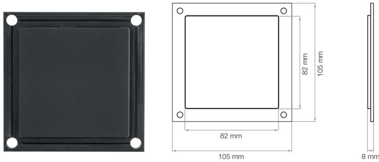
Le module obturateur fait office de pièce intercalaire pour le poste extérieur modulaire. Il peut par la suite être remplacé par une fonction supplémentaire (un module serrure à code ou un module lecteur de transpondeur par exemple). Le module est réalisé en plastique noir et en verre acrylique transparent.
