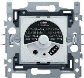
Socle pour un variateur à bouton rotatif universel avec déparasitage TCC, d'une puissance de 5 à 325 W. Un set de finition XXX-31003 et une plaque de recouvrement d'une couleur au choix doivent être commandés séparément.
