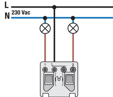
Mechanismus für einen Schalter mit 2 Kreisläufen, mit Krallenbefestigung. Ein Zweikreisschalter hat zwei Tasten und kann zum Ein- und Ausschalten von zwei separaten Lampen verwendet werden. Zentralplatte und Rahmen in der Farbe Ihrer Wahl müssen separat bestellt werden.
