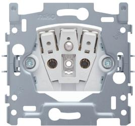
Mécanisme pour une prise de courant avec broche de terre, avec fixation par griffes et avec obturateurs de protection. La profondeur d'encastrement de cette prise de courant est de 28,5 mm. Un set de finition et une plaque de recouvrement d'une couleur au choix doivent être commandés séparément.
