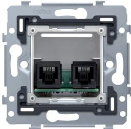
Mechanismus für eine Kontakt-dose mit 2 RJ11-Eingängen für Telefonie, mit Schraubbefestigung. Neben jedem Eingang befindet sich ein Telefonsymbol. Eine Zentralplatte in der gewünschten Farbe muss separat bestellt werden.
