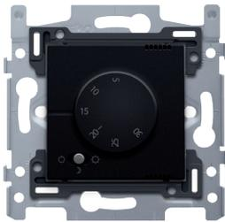
Ce thermostat électronique vous permet de commander le chauffage central, le chauffage électrique ou la climatisation. Il possède 2 modes de fonctionnement (chauffage et climatisation) et 3 positions (marche et jour, éco et nuit, arrêt et veille). Couleur de finition: black coated
