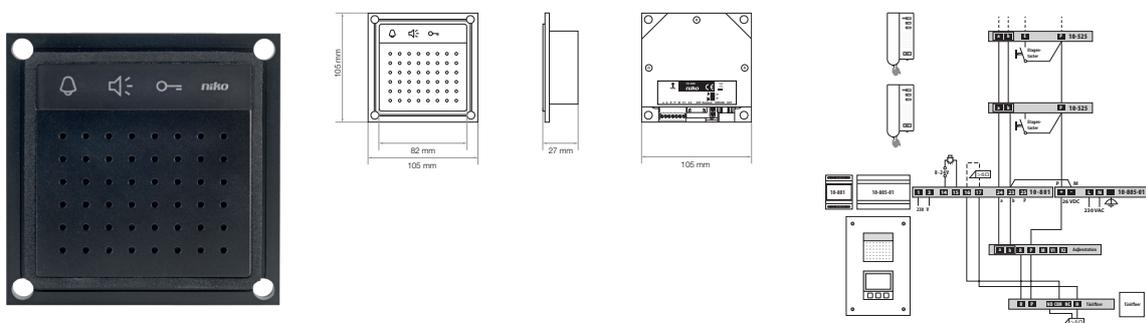
Le module audio permet d'activer un appel de porte, de converser et, éventuellement, d'ouvrir la porte. Le module est en aluminium anodisé noir.
