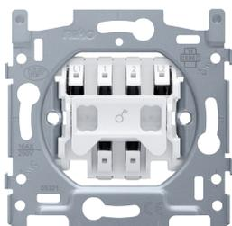
Mécanisme pour un interrupteur bipolaire 16 A, un interrupteur témoin bipolaire 16 A ou un interrupteur à tirage bipolaire 16 A, avec fixation par vis. Un interrupteur bipolaire vous permet d'allumer ou d'éteindre une seule lampe ou plusieurs lampes commutées en parallèle. Un set de finition et une plaque de recouvrement d'une couleur au choix doivent être commandés séparément.
