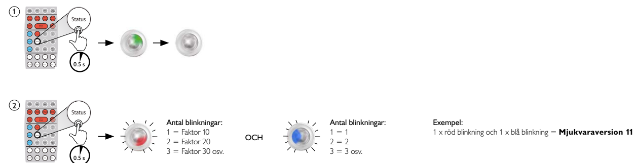
Fig. 9.2 Kontrollera mjukvaraversion via IR fjärrkontroll
