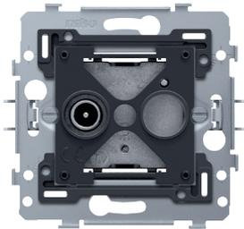
Mechanismus für einen einfachen Koaxialanschluss für TV, mit Krallenbefestigung. Neben dem Eingang befindet sich der Aufdruck „TV“. Eine Zentralplatte in der gewünschten Farbe muss separat bestellt werden.
