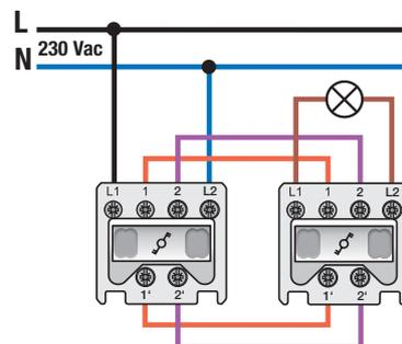
Mécanisme pour un interrupteur va-et-vient bipolaire, avec fixation par vis. Les interrupteurs va-et-vient sont utilisés pour commander une même lampe à partir de deux endroits différents. Un set de finition et une plaque de recouvrement d'une couleur au choix doivent être commandés séparément.
