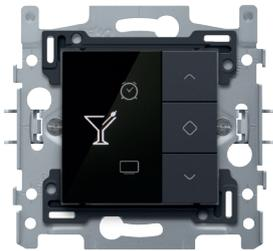
Cette commande est raccordée directement à l'installation et est utilisée pour régler et activer l'ambiance voulue. Les ambiances peuvent être activées automatiquement grâce à des capteurs. Cette commande se monte dans une boîte d'encastrement à une hauteur de 140 à 150 cm au-dessus de la surface du sol.
