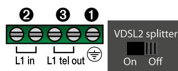
→ 3 Connecter le module à l'installation intérieure
