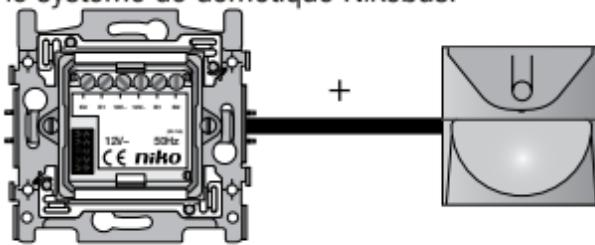
Le détecteur de mouvement (capteur) est exclusivement destiné à une utilisation à l'intérieur, dans un environnement dont le degré hygrométrique de l'air ne prête pas à la condensation. Ce capteur est combiné avec un socle Nikobus (actuateur) à deux entrées, sur lequel un bouton-poussoir externe (phase L, 12 Vac) peut être raccordé. Ce bouton-poussoir permet de commander le détecteur de mouvement depuis plusieurs endroits.
