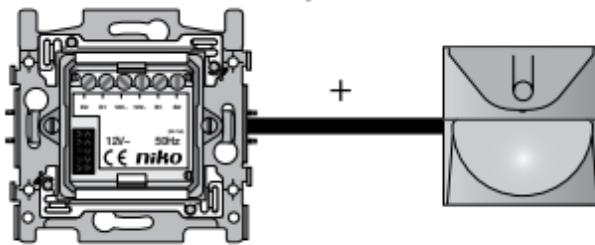
De bewegingsmelder (sensor) is uitsluitend geschikt voor gebruik binnenshuis in een omgeving met een niet-condenserende luchtvochtigheid. Deze sensor wordt gecombineerd met een Nikobus sokkel (actor) met twee ingangen waarop een externe drukknop (fase L, 12 Vac) kan worden aangesloten. Met deze drukknop kun je de bewegingsmelder vanop verschillende locaties bedienen.
