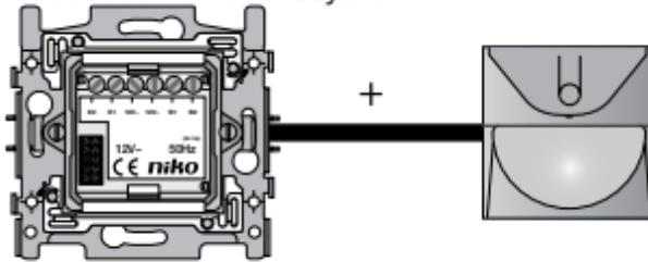
Der Bewegungsmelder (Sensor) ist ausschließlich für eine Verwendung in Innenräumen und in einer Umgebung mit nicht-kondensierender Luftfeuchtigkeit geeignet. Dieser Sensor wird mit einem Nikobus-Sockel (Aktor) mit zwei Eingängen kombiniert, an denen ein externer Tastschalter (Phase L, 12 Vac) angeschlossen werden kann. Mit diesem Tastschalter können Sie den Bewegungsmelder von unterschiedlichen Orten bedienen.
