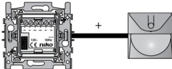
Detektor pohybu (snímač) je určený na použitie iba vo vnútornom prostredí s nekondenzujúcou vlhkosťou vzduchu. Tento snímač je zložený z prístrojového spodku Nikobus (aktor) s dvoma vstupmi, ku ktorému je možné pripojiť externé tlačidlo (fáza L, 12 Vac).
