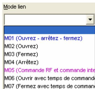
Si la sortie sélectionnée fait partie d'un module de commande, le menu se présente comme ci-dessous.
