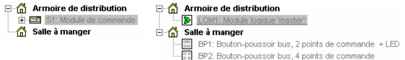
Déterminez le bouton-poussoir **BP1** comme **BP1: Touche Shift**. Choisissez pour le **BP2** la dénomination **BP2: Eclairage intérieur et extérieur**. Les 4 points de commande du **BP2** commandent les sorties 1 à 4 du module de commande en mode télérupteur **M05** si la touche Shift n'est pas enclenchée (basse) et les sorties 7 à 10 également en mode **M05** si la touche est enclenchée (haute).
