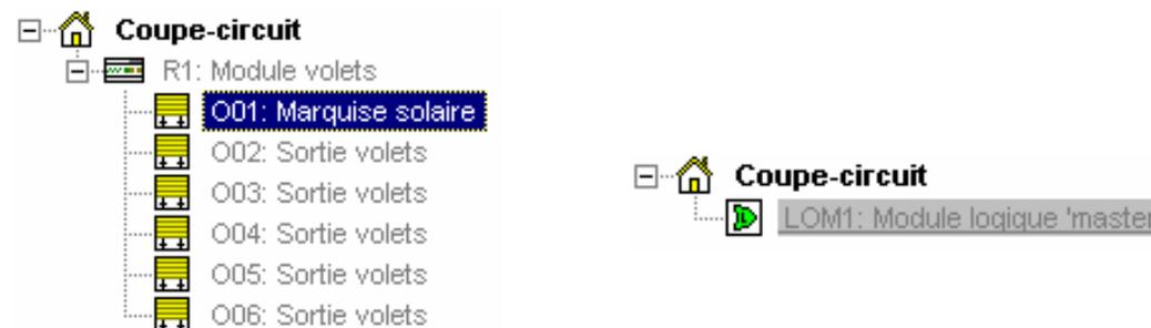
Remarquez que la marquise est reliée à la première sortie du module volets. Reliez l'anémomètre à l'entrée **LM01: entrée locale 1** du module **PC-Logic**. Reliez le capteur solaire à **LM02: entrée locale 2** du **PC-Logic**.
