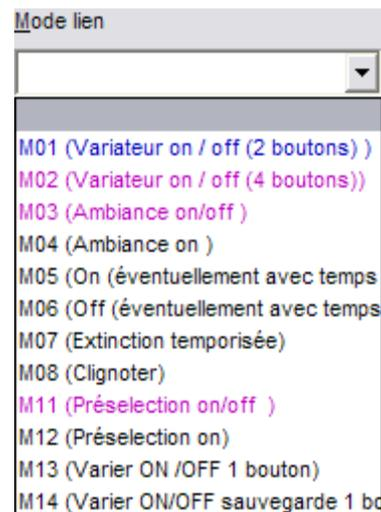
Sélectionnez la sortie du dimcontroller compact à programmer. Choisissez ensuite dans la case **Mode lien**, la fonction désirée. Les modes à un seul bouton sont indiqués ici en noir, les modes à 2 boutons en bleu et ceux à 4 boutons en mauve.
