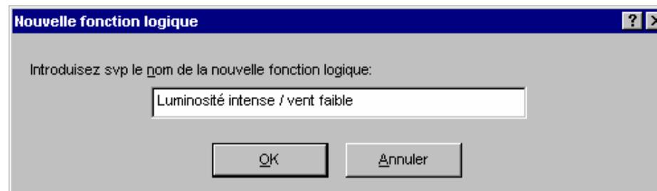
Quittez l'écran avec la touche **OK**. La nouvelle fonction est sélectionnée dans la fenêtre **Editeur de fonction logique**. Placez les entrées LM01 et LM02 dans la grille logique. Annotez pour **LM01**, la fonction **Off / on** et pour **LM02** (capteur solaire) la fonction **On / off**. Ne modifiez rien aux fonctions **ET**. Vous obtenez l'image suivante:
