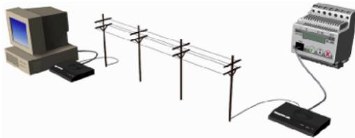
Nous avons vu au chapitre **15.13 Ecrans de téléchargement de et vers l'installation**, comment télécharger le programme d'ordinateur vers l'installation au moyen d'une connexion directe entre ordinateur et installation. Il est possible d'effectuer également toutes ces opérations à distance. Les accessoires nécessaires pour réaliser ceci, sont deux modems et une ligne téléphonique.
