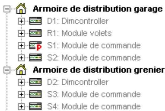
Il vous reste maintenant à ajouter quelques modules dans la seconde armoire de distribution. Sélectionnez **Armoire de distribution grenier** et procédez de la même manière que pour les modules de l'armoire du garage. Ajoutez un dimcontroller et deux modules de commande.
