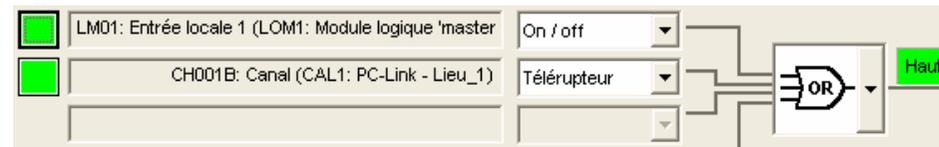
Une sortie est 'haute' lorsqu'une des entrées est ou les deux entrées sont 'hautes'.
