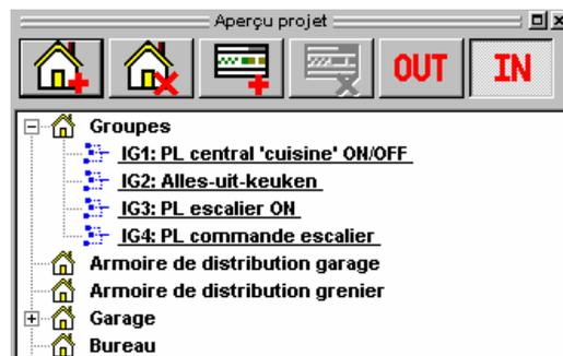
La fenêtre **Aperçu du projet** comporte une structure en arbre. Son contenu est assujéti à la position des boutons **IN** et **OUT**. Quand le bouton **OUT** est activé, les sorties et les groupes de sorties des modules sont visibles dans la structure en arbre. Quand le bouton **IN** est activé, les modules d'entrées et groupes d'entrée comme boutons-poussoirs, modules PC-Logic et modules PC-Link sont visibles.
