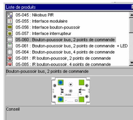
Sous le nom **Garage**, dans **Aperçu du projet** apparaît la dénomination: **BP1: bouton-poussoir, 2 points de commande**. Le CODE du bouton-poussoir est visible dans la fenêtre info.
