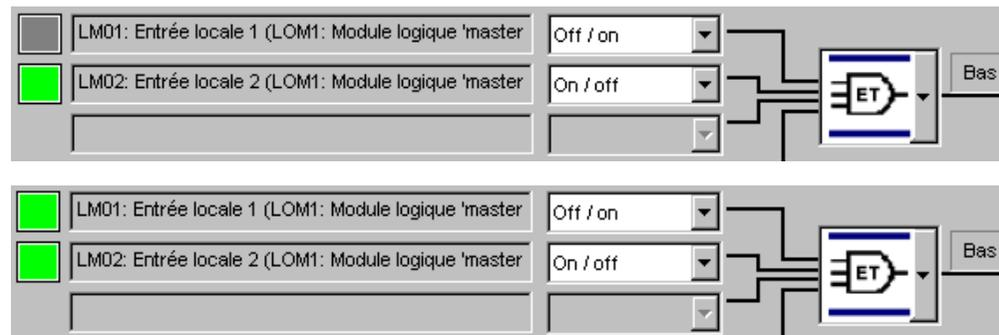
La sortie de la fonction logique reste 'basse' aussi longtemps qu'une des entrées et/ou les deux entrées sont hautes (carré vert). La sortie se trouve haute, lorsque les deux entrées sont basses. Quittez l'écran **Simulation** par la touche **OK**.
