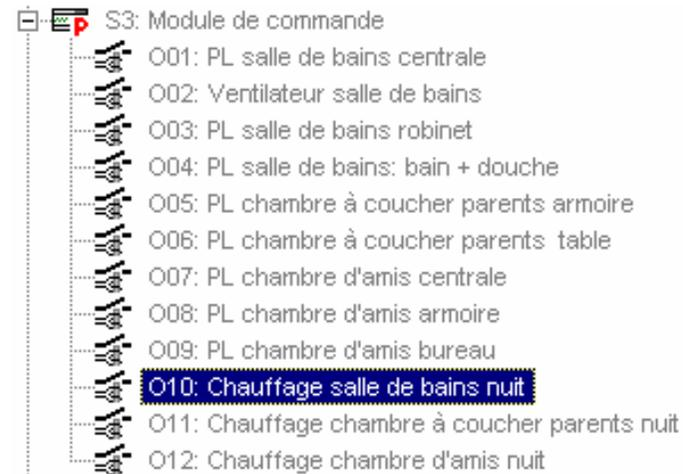
La sortie **010: Chauffage nuit salle de bains** est prévue au **module de commande S3** du projet. Cliquez sur le bouton **Modifier nom du canal**. L'écran suivant apparaît dans lequel vous pouvez modifier le nom du canal en: **Chauffage salle de bains nuit-semaine**.
