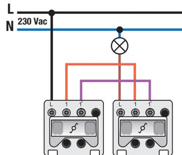
Mechanismus für einen Wechselschalter oder Wechsel-Zugschalter, mit Krallenbefestigung. Wechselschalter werden verwendet, um eine Lampe von zwei verschiedenen Orten aus zu bedienen. Zentralplatte und Rahmen in der Farbe Ihrer Wahl müssen separat bestellt werden.
