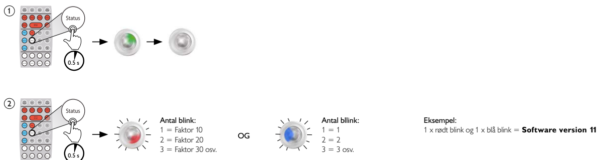
Fig. 11.1 Kontroller software version via IR-fjernbetjening
