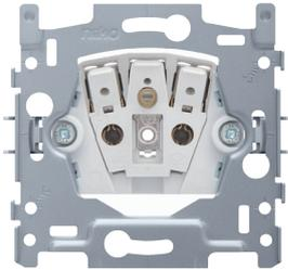
Mechanismus für eine Wandsteckdose ohne Erdung, mit Krallenbefestigung und mit integriertem erhöhten Berührungsschutz. Diese Wandsteckdose hat eine Einbautiefe von 21 mm. Eine Zentralplatte und eine Blende in der gewünschten Farbe müssen separat bestellt werden.
