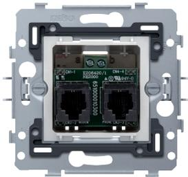
Einbausockel mit Schraubklemmen und Befestigungskrallen mit RJ11 Ausgang und ADSL-Ausgang, mit Krallenbefestigung. Dieser ADSL-Splitter kann ebenfalls mit ADSL2, ADSL2+ und VDSL2 verwendet werden.
