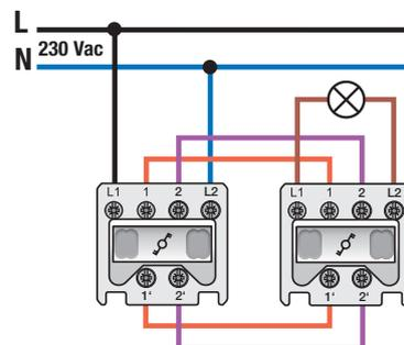
Mechanizmus pre 2-pólový dvojsmerný spínač s rozperkami. Dvojsmerné spínače sa používajú na ovládanie osvetlenia z dvoch rôznych miest. Stredový kryt a rámček vo farbe podľa vášho výberu musíte objednať samostatne.
