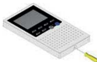
Abb. 7: Öffnen der Innenstation
