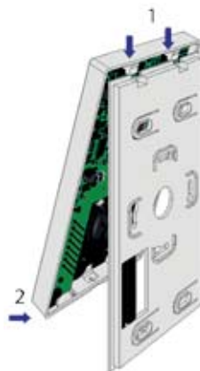
Fig. 6 : Monter le cadre supérieur
