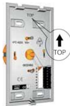
Abb. 2: Unterschale montieren
