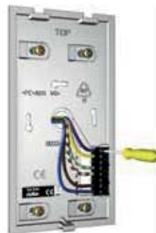
Abb. 3: Leitungen anschließen
