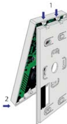
Obr. 6: Montáž horného rámu
