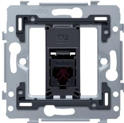
Dieser Mechanismus mit einem (1) RJ11 Verbindungspunkt wird für den Anschluss von einem (1) Telefon verwendet. Er ist sternförmig zum zentralen Kabelverzweiger angeschlossen. Die Innenabmessungen des Unterputzrahmens betragen 45 x 45 mm und die Außenabmessungen 71 x 71 mm x 71 mm. Zudem ist der Unterputzrahmen mit Schraubbefestigung ausgestattet. Zentralplatte und Rahmen in der Farbe Ihrer Wahl müssen separat bestellt werden.
