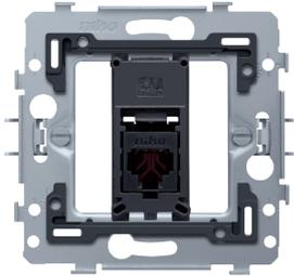
Dieser Mechanismus mit einem (1) RJ11 Verbindungspunkt wird für den Anschluss von einem (1) Telefon verwendet. Er ist sternförmig zum zentralen Kabelverzweiger angeschlossen. Die Innenabmessungen des Unterputzrahmens betragen 45 x 45 mm und die Außenabmessungen 71 x 71 mm x 71 mm. Zudem ist der Unterputzrahmen mit Krallenbefestigung ausgestattet. Zentralplatte und Rahmen in der Farbe Ihrer Wahl müssen separat bestellt werden.
