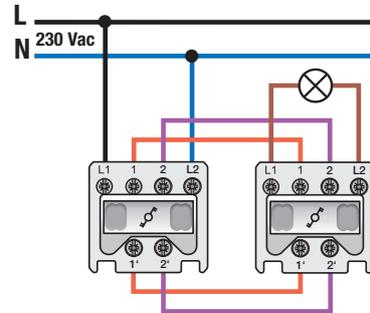
Mechanismus für einen zweipoligen Wechselschalter, mit Krallenbefestigung. Wechselschalter verwenden Sie, um eine Lampe von zwei verschiedenen Orten aus zu bedienen. Eine Zentralplatte und eine Blende in der gewünschten Farbe müssen separat bestellt werden.
