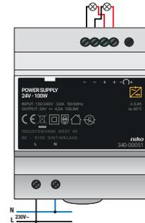
Cette alimentation convient pour l'alimentation de LED et est conçue pour un montage sur rail DIN. Sa puissance est de 100 W. Cette alimentation satisfait aux normes européennes EN 61347-2-13 pour la CEM et la sécurité.
