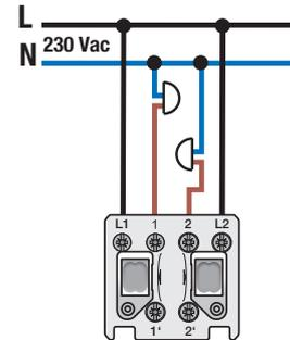
Mechanismus für einen Taster mit Schließer- bzw. Öffnerkontakt mit zwei Tasten, mit Krallenbefestigung. Zentralplatte und Rahmen in der Farbe Ihrer Wahl müssen separat bestellt werden.
