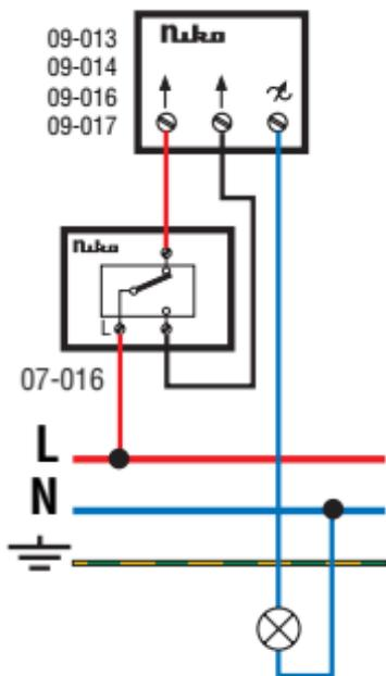
Wisselschakeling: schakelaar aan de belastingszijde
